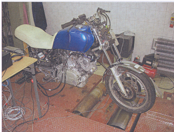
Rys.3.2.2 Motocykl na stanowisku badawczym
