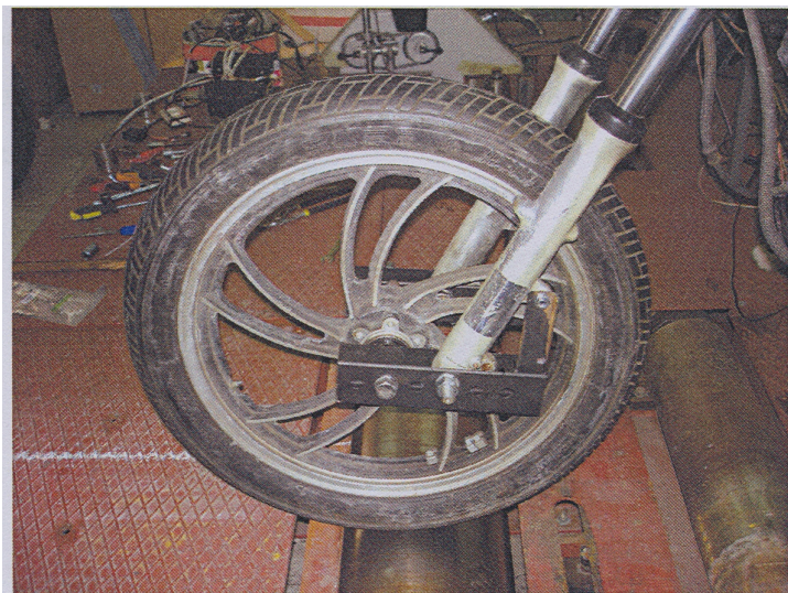
Rys.3.2.4 .Zmiana odcinka wyprzedzenia - zmniejszenie
