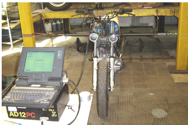
Rys. 2.4 Pomiar momentu bezwładności motocykla względem osi wzdłużnej w płaszczyźnie jezdni.
