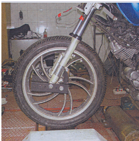
Rys.3.2.5. Zmiana odcinka wyprzedzenia – zwiększenie
