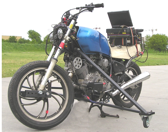
Rys. 3.3.1 Motocykl badawczy wraz z aparaturą pomiarową i podporami.
