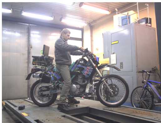
Rys.2.2 Wyznaczanie momentu bezwładności motocykla względem osi pionowej na stanowisku karuzelowym.
