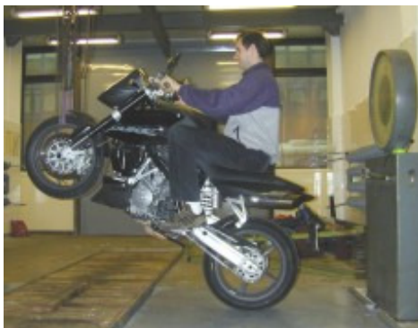
Rys.2.1 Wyznaczanie położenia wysokości środka masy motocykla.
