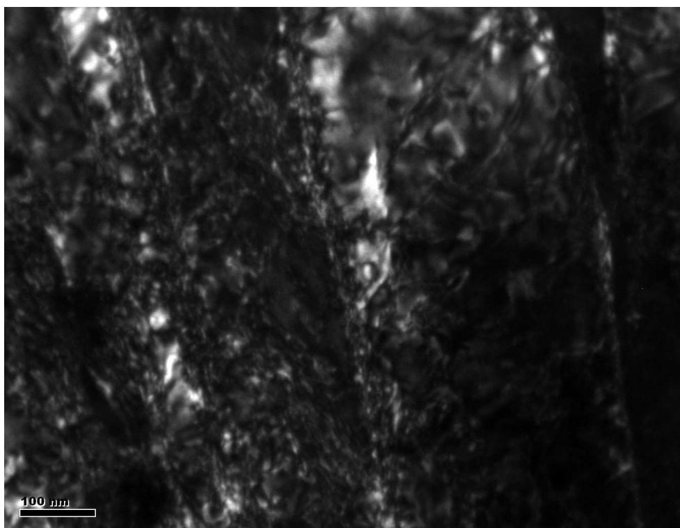
Rys. 53. Mikrostruktura o budowie listwowej w stali z wytopu W5 po hartowaniu w wodzie, obraz TEM ciemne pole widzenia
