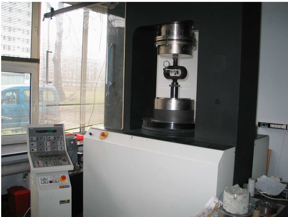
Rys. Z2.35. Cechowanie prasy elektronicznej „Instron”
