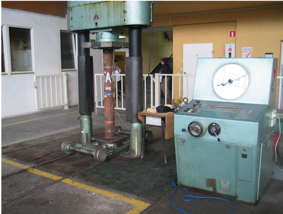
Rys. Z2.13. Element 6A10 obciążany w prasie DB600.
