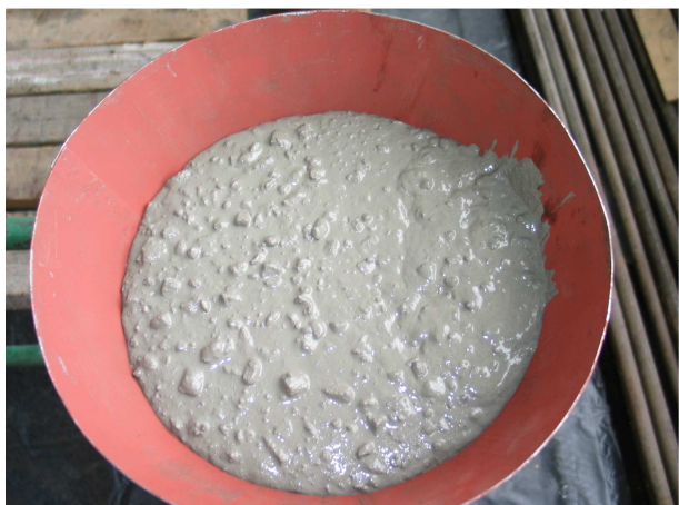
Z2.4. Lejek wypełniony mieszanką betonową.
