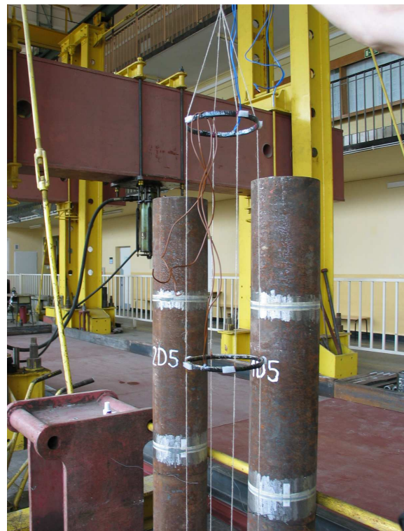
Rys. Z2.10. Tensometry pierścieniowe, seria D.
