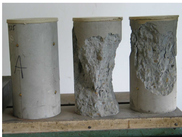
Rys. Z2.31. Próbkii serii A po zbadaniu modułu sprężystości tensometrem nasadowym.
