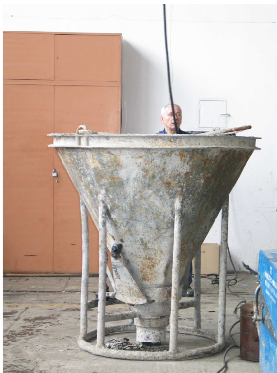
Rys. Z2.2. Zbiornik z mieszanką betonową.
