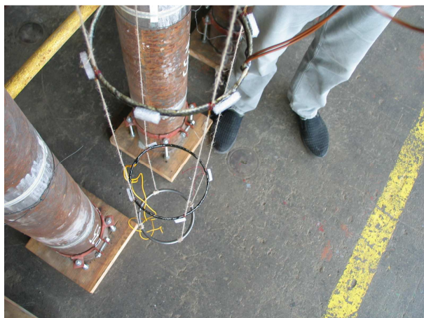
Rys. Z2.12. Tensometry w seriach B, C, D, E
