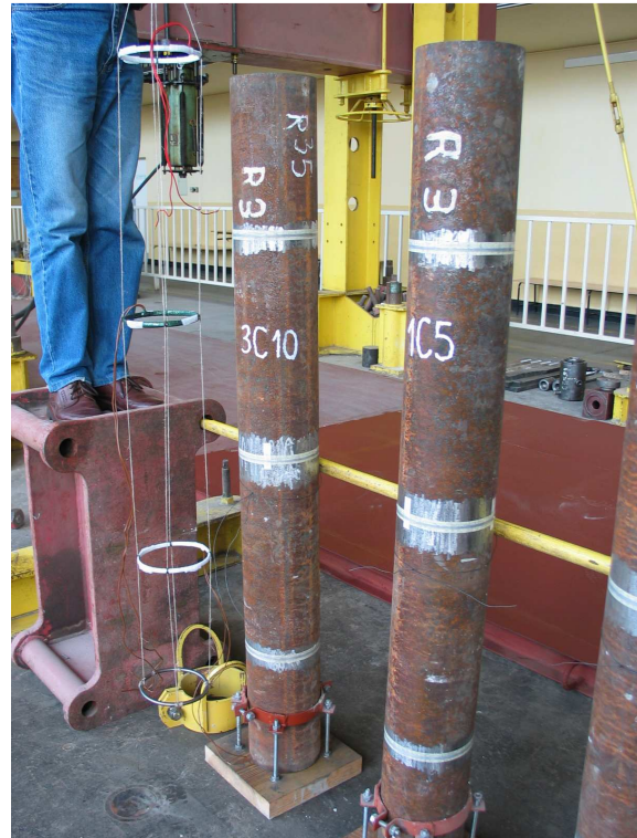
Rys. Z2.8 Tensometry pierścieniowe w serii C.
