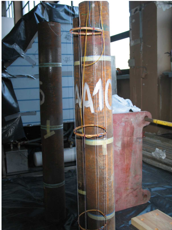
Rys. Z2.7. Tensometry pierścieniowe w serii A.
