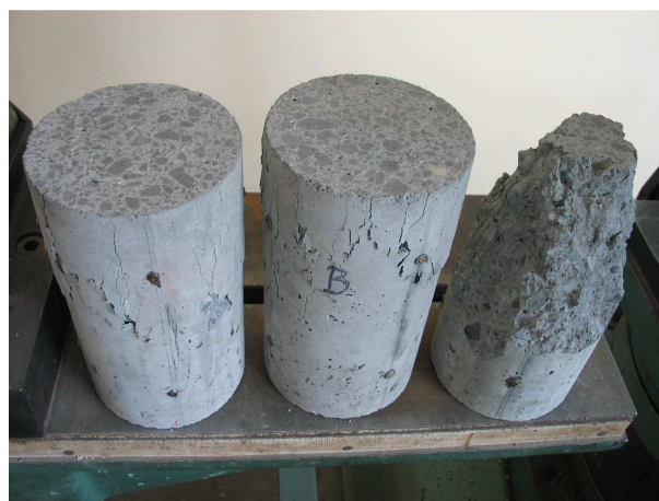
Rys. Z2.32. Próbkii serii B po zbadaniu modułu sprężystości tensometrem nasadowym.
