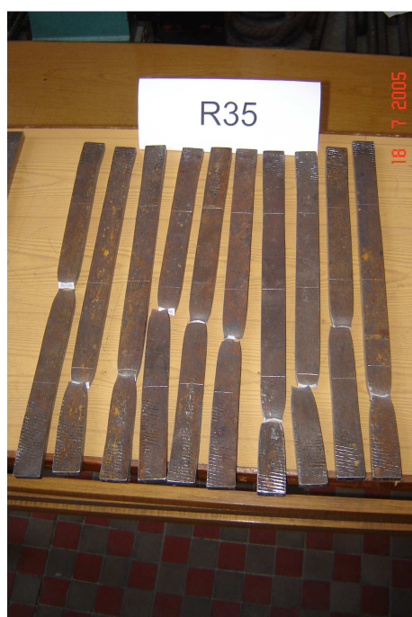
Rys. Z2.28. Próbki ze stali R35.
