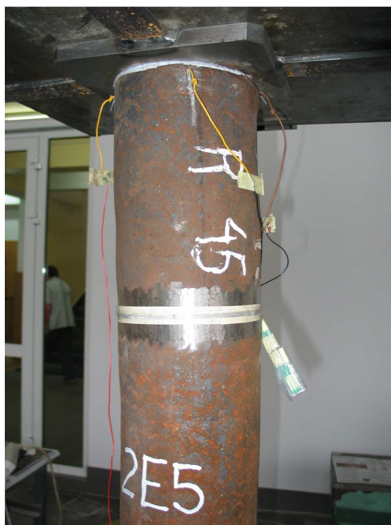
Rys. Z2.22. Pofalowana górną część rury.
