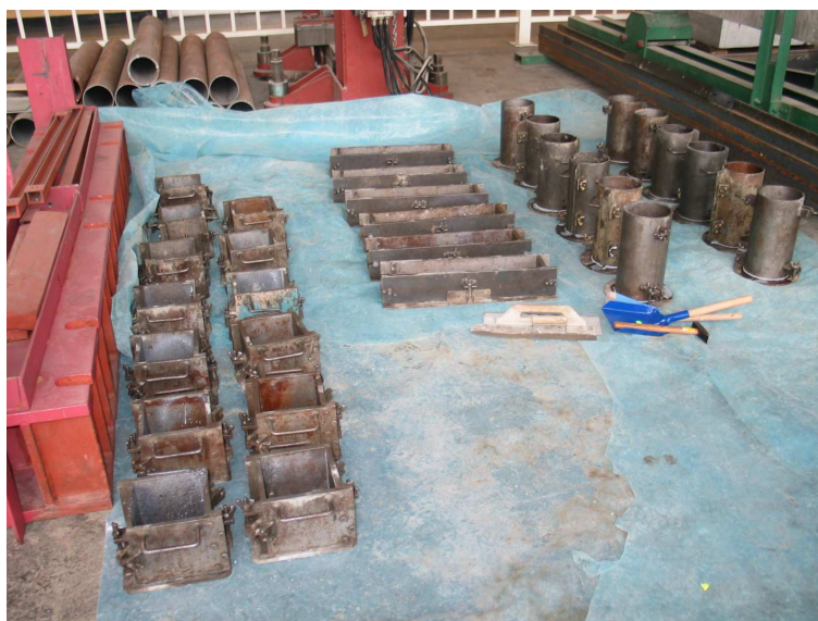
Z2.6. Zestaw form przygotowanych do betonowania próbek.
