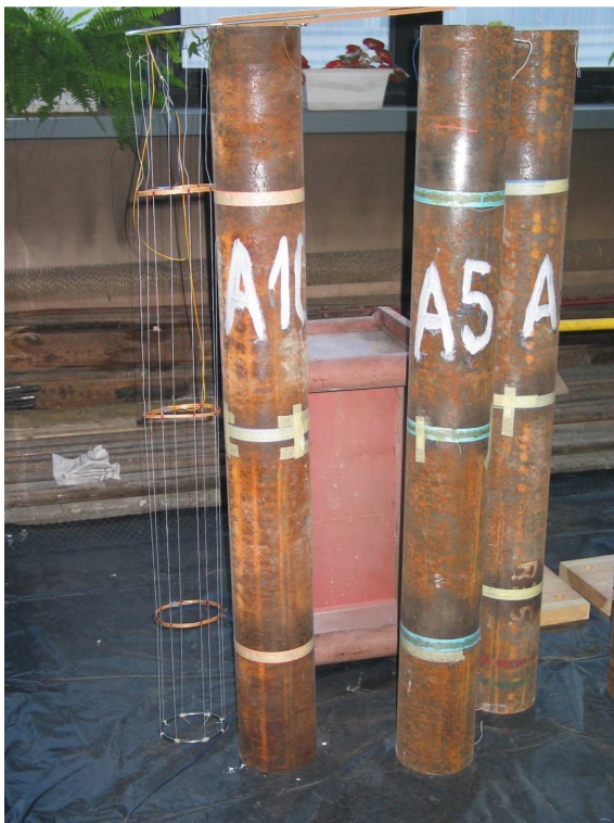
Rys. Z2.9. Zakładanie tensometrów w serii A.
