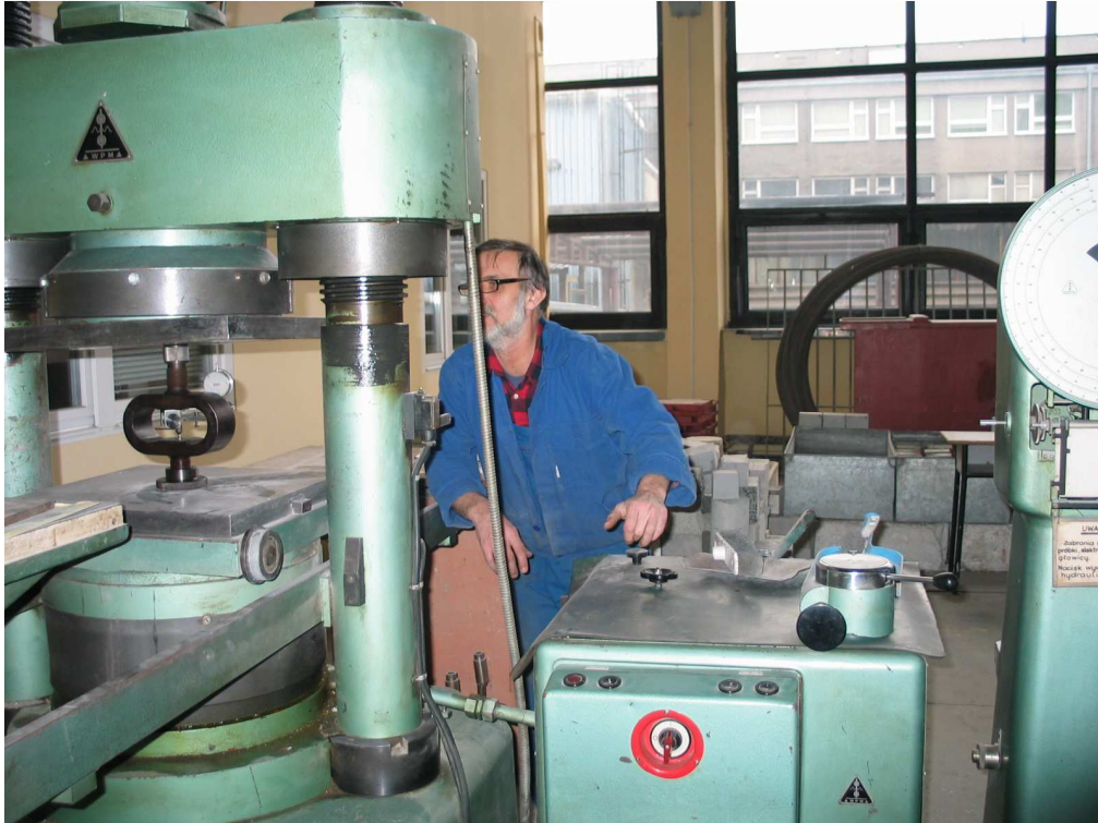
Rys. Z2.36. Cechowanie prasy DB300.
