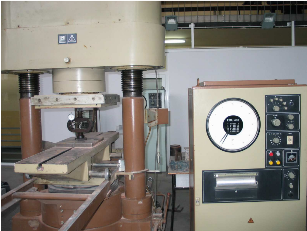
Rys. Z2.34. Cechowanie prasy EDU 400 przy pomocy dynamometru.
