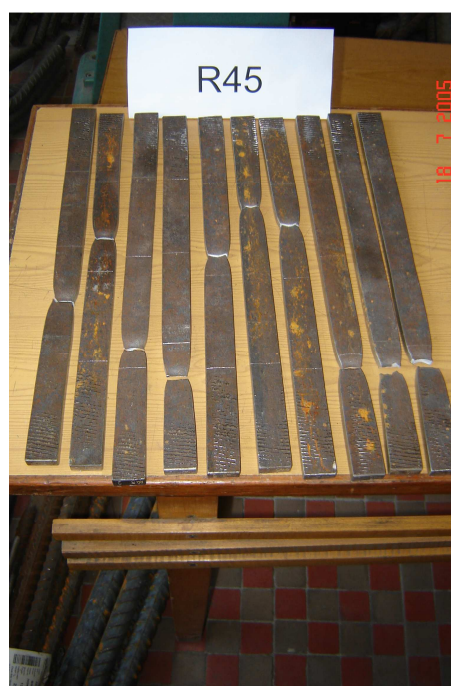
Rys. Z2.29. Próbki ze stali R45.
