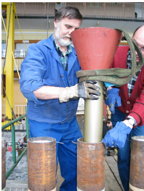
Rys. Z2.1. Wypełnianie rur przy pomocy lejka.
