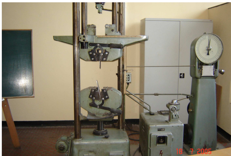
Rys. Z2.27. Rozciąganie próbek w maszynie wytrzymałościowej.
