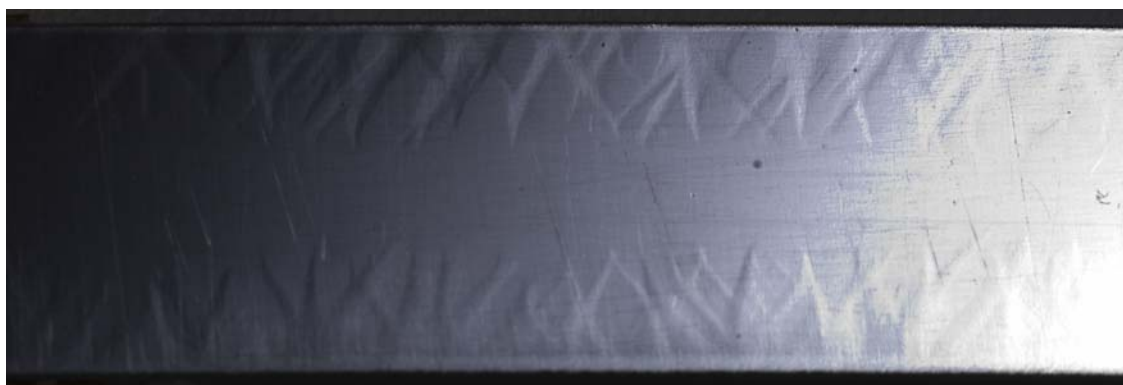
Rys. 5.4. Fotografia poślizgów plastycznych w belce zginanej stałym momentem
