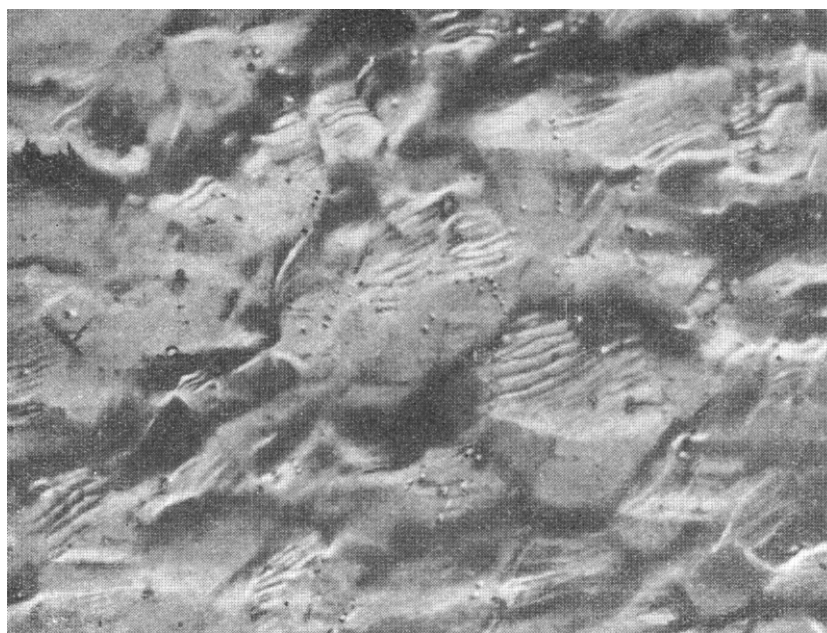
Rys. 3.3. Fotografia struktury próbki stalowej wykonana po osiągnięciu nieznacznych odkształceń plastycznych. Fotografie wykonano na brzegu powierzchni uplastycznionej. Powiększenie 70\times . [18]
