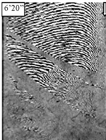
Rys. 4.7. Stal 15HM. Wycinek platformy plastycznej wykresu rozciągania z zaznaczonymi współrzędnymi \sigma - \varepsilon i odpowiadające im czasy występowania na filmie wideo. (plik STAL 15HM)
