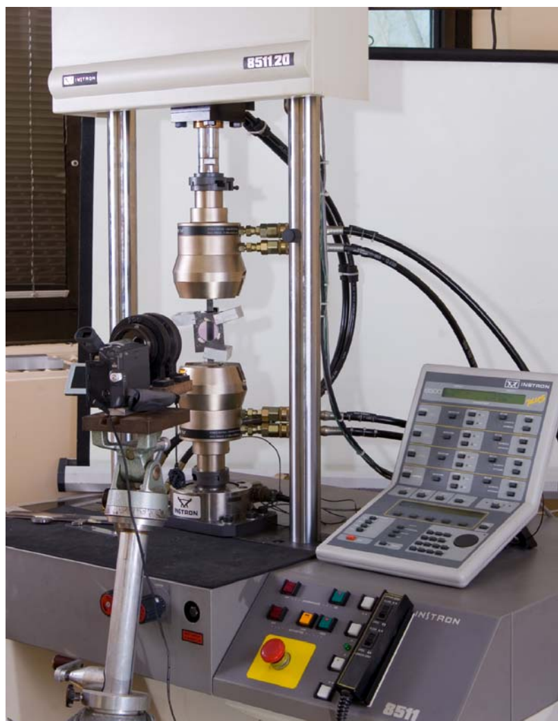
Rys.4.2. Stanowisko do badań nad propagacją odkształceń plastycznych w próbce rozciągania
