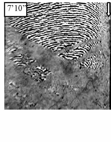
Rys. 4.7. Stal 15HM. Wycinek platformy plastycznej wykresu rozciągania z zaznaczonymi współrzędnymi \sigma - \varepsilon i odpowiadające im czasy występowania na filmie wideo. (plik STAL 15HM)
