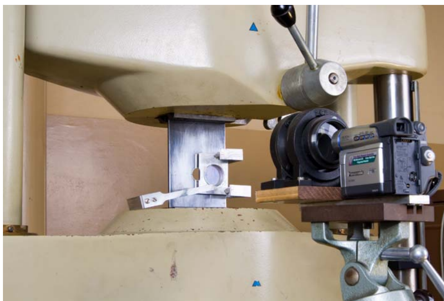
Rys. 5.9. Tarcza z otworem po badaniach na maszynie wytrzymałościowej
