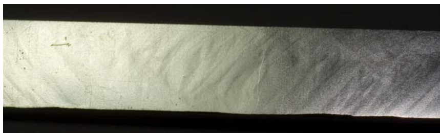
Rys. 4.6. Stal 15HM. Widok linii Lüdersa na próbce po osiągnięciu granicy plastyczności
