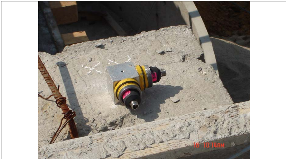
Rys. 4.5. Kostka aluminiowa z akcelerometrami umiejscowiona w punkcie pomiarowym.
