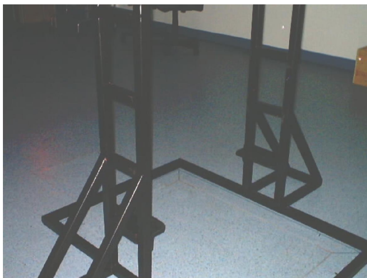
Rys. 65. Zeskocznia do pomiarów zaprojektowana przez autora i zamontowana nad platformą dynamometryczną wbudowaną w podłogę
