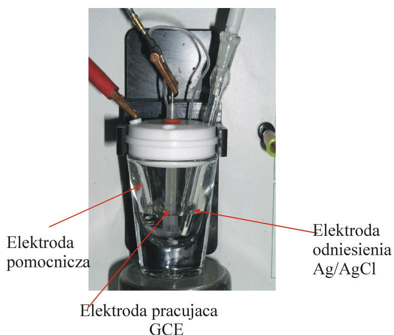
Rys. 24. Naczynko elektrolityczne wyposażone w trzy elektrody: pomocniczą - drut Pt, pracującą - GCE (lub metalowa), odniesienia - Ag/AgCl w 3 M NaCl w kluczu elektrolitycznym
