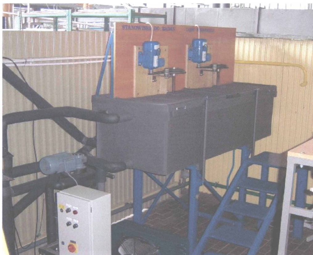
Rysunek 4.1.4. Zbiornik magazynujący wytworzony lód zawieszinowy
