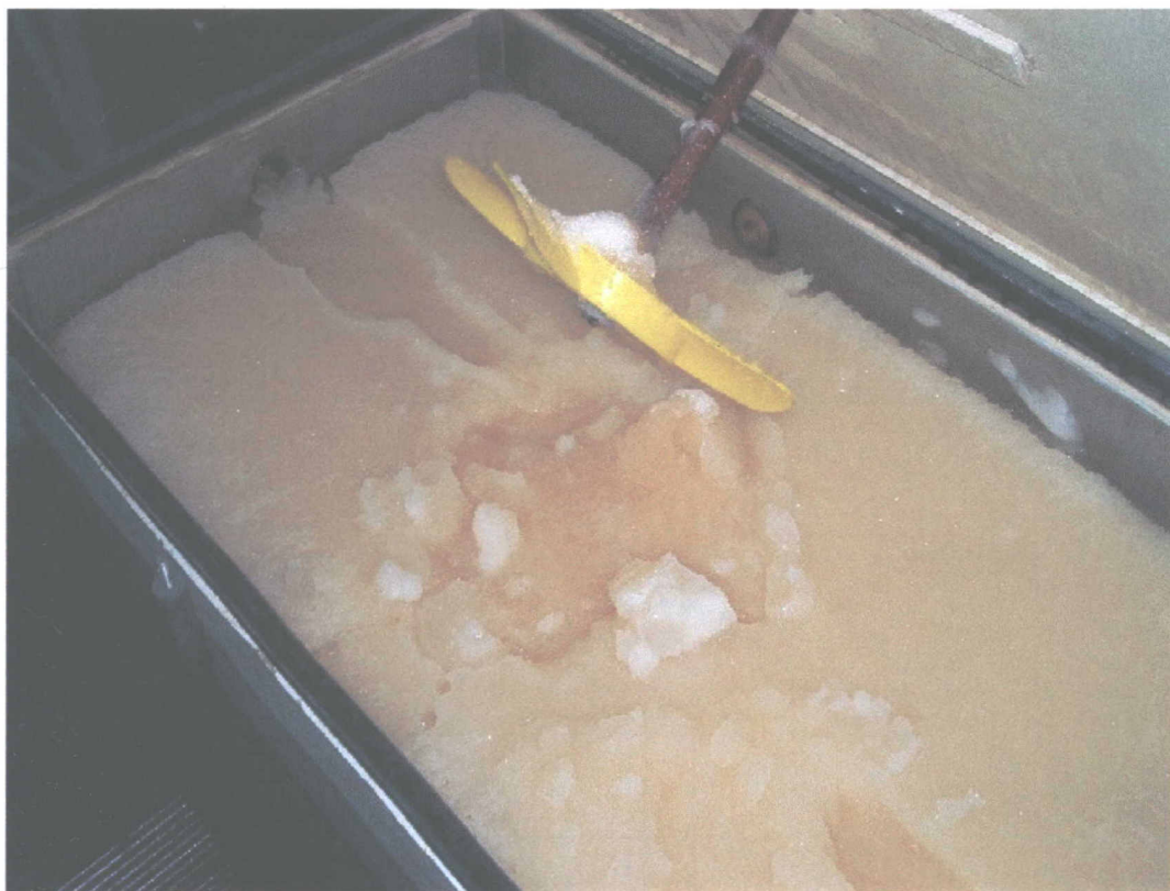
Rysunek 4.1.5. Rozwarstwiony lód zawieszinowy oraz fragment mieszadła
