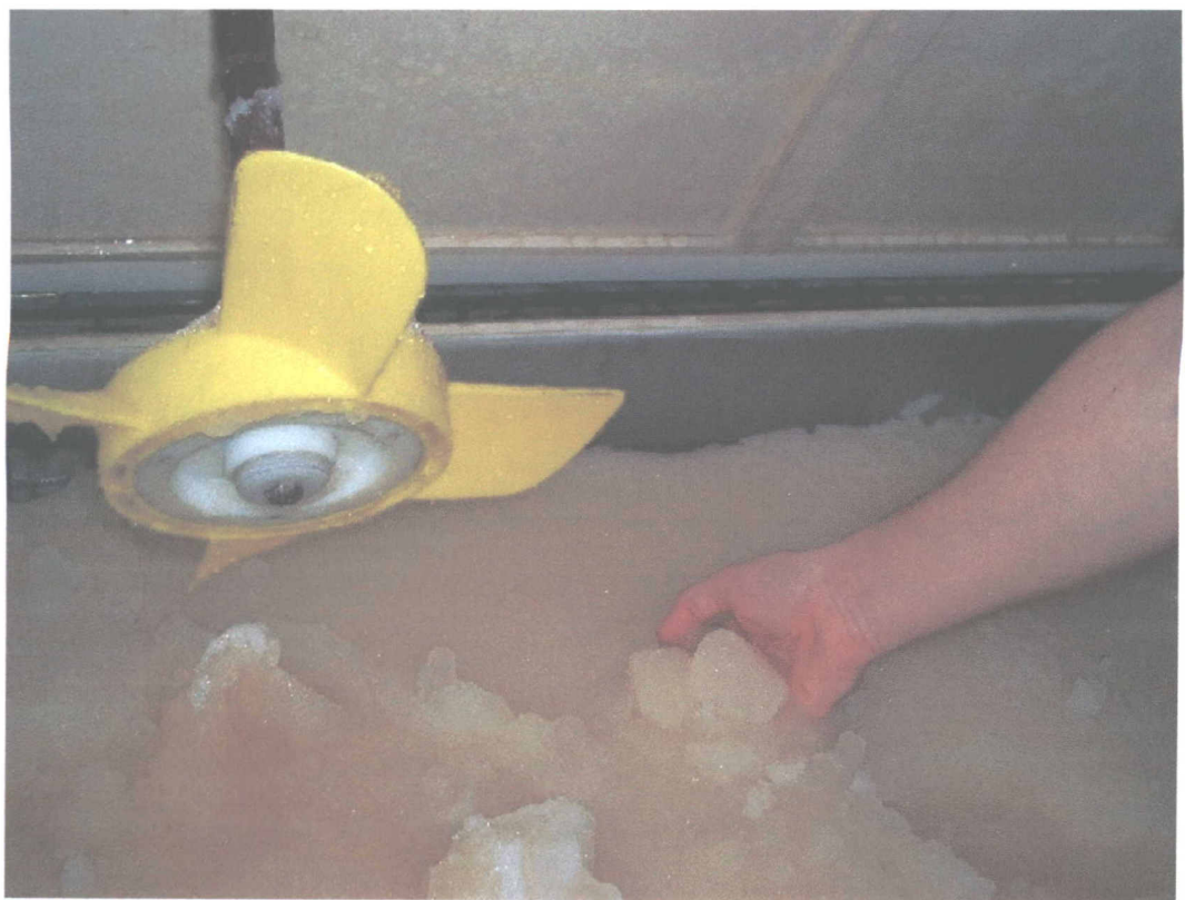
Rysunek 4.1.6. Jedno z dwóch mieszadeł zamontowanych w zbiorniku lodu zawieszinowego
