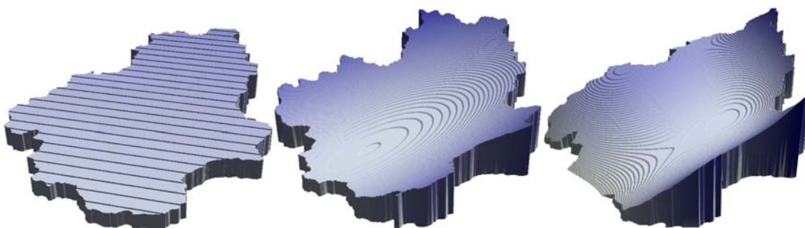
Rysunek III.4. Przykład zastosowania metody interpolacji wielomianowej – wielomiany pierwszego, drugiego i trzeciego rzędu. Źródło: opracowanie własne
