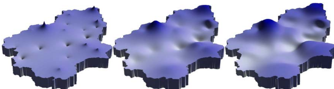
Rysunek III.2. Przykład zastosowania metody odwrotnych odległości dla wykładników potęgi k = 1, 2, 3 .
