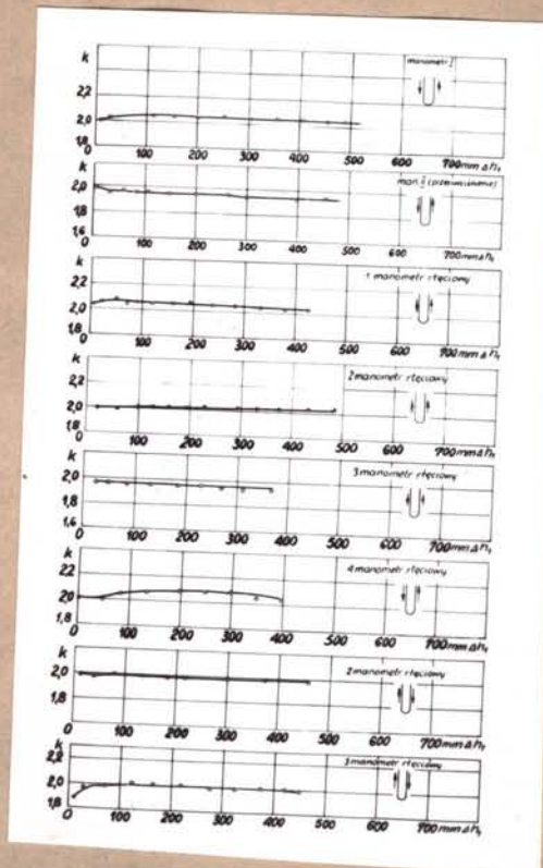
Rys.38. Współczynniki k = f(\Delta h_i) dla różnych manometrów z wzorcowania o - punkty z pomiaru
