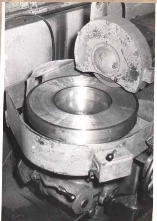
Rys.13. Szlifowanie powierzchni czołowych matrycy regeneratora Katedry CMP PŁ
