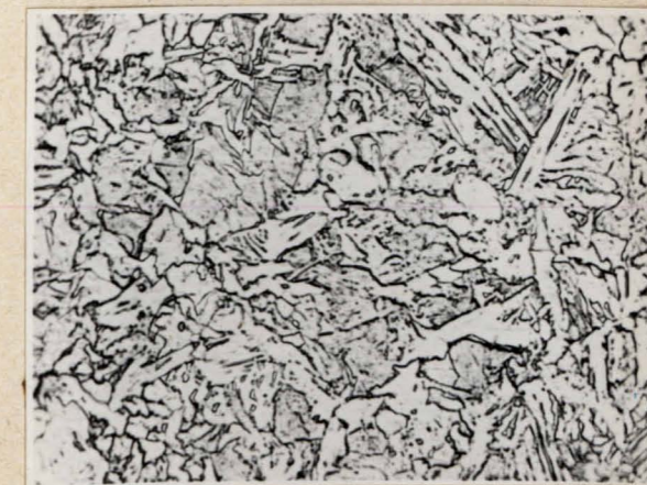
Rys. 9f Struktura stali chłodzonej wg krzywej I
