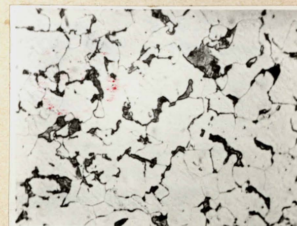
Rys. 10d Struktura stali chłodzonej wg krzywej III
