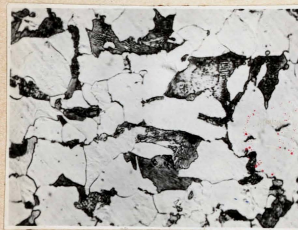
Rys. 9c Struktura stali chłodzonej wg krzywej IV
