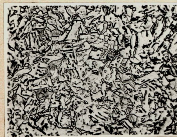
Rys. 15e Struktura stali chłodzonej wg krzywej II
