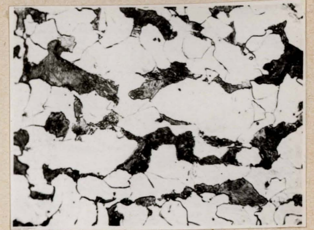
Rys. 8b Struktura stali chłodzonej wg krzywej V
