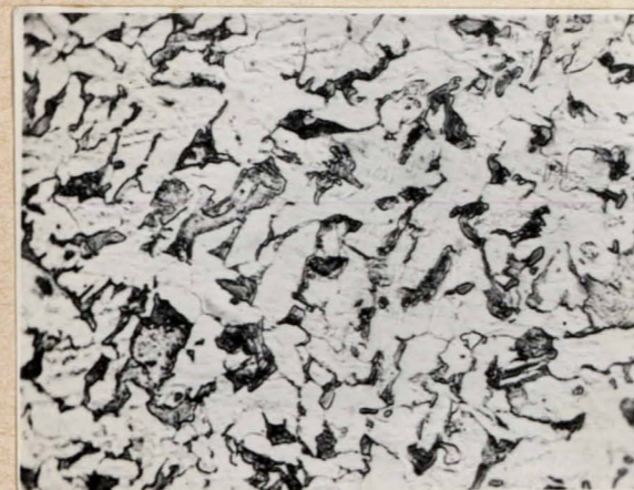
Rys. 9e Struktura stali chłodzonej wg krzywej II
