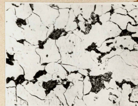
Rys. 10b Struktura stali chłodzonej wg krzywej V
