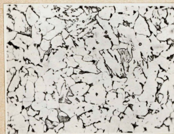
Rys. 10e Struktura stali chłodzonej wg krzywej II
