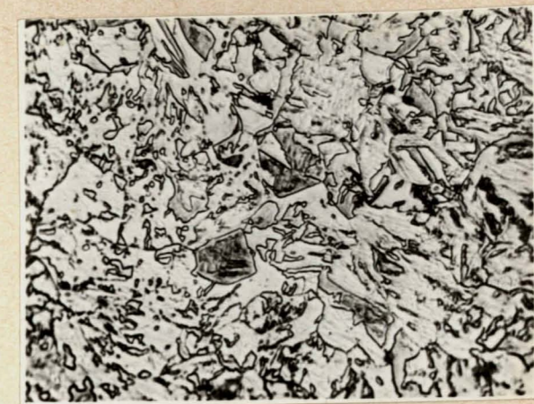
Rys. 13b Struktura stali chłodzonej wg krzywej V
