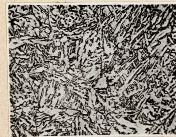
Rys. 12e Struktura stali chłodzonej wg krzywej II
