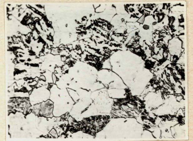
Rys. 12b Struktura stali chłodzonej wg krzywej V
