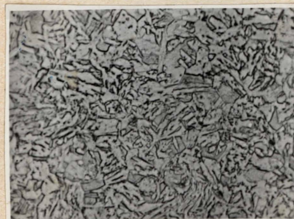
Rys. 11e Struktura stali chłodzonej wg krzywej II
