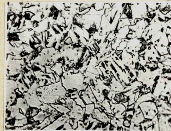
Rys. 15c Struktura stali chłodzonej wg krzywej IV
