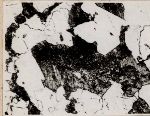
Rys. 8a Struktura stali chłodzonej wg krzywej VI
