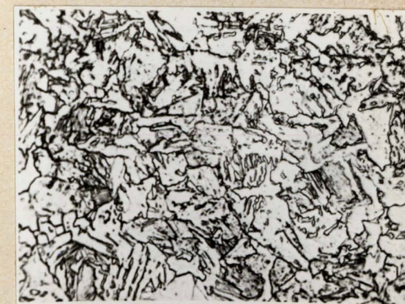
Rys. 10f Struktura stali chłodzonej wg krzywej I
