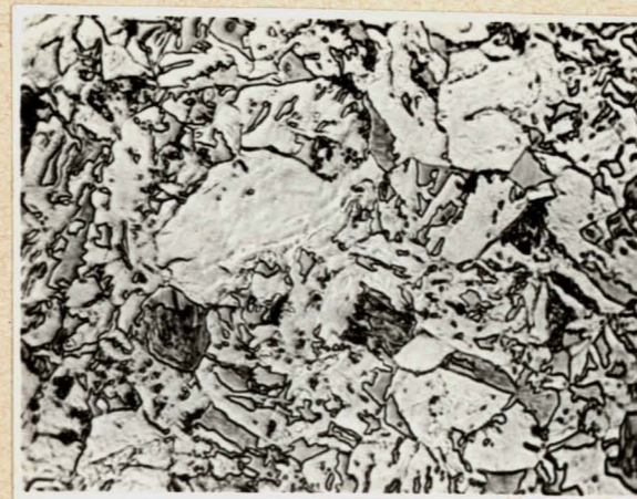
Rys. 13a Struktura stali chłodzonej wg krzywej VI
