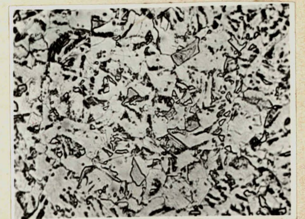
Rys. 15d Struktura stali chłodzonej wg krzywej III
