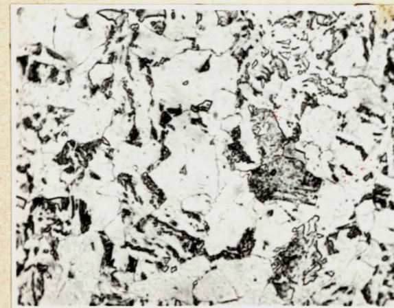
Rys. 12c Struktura stali chłodzonej wg krzywej IV
