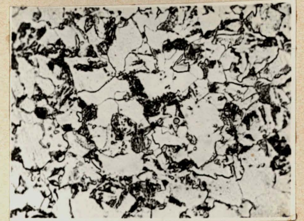
Rys. 15b Struktura stali chłodzonej wg krzywej V
