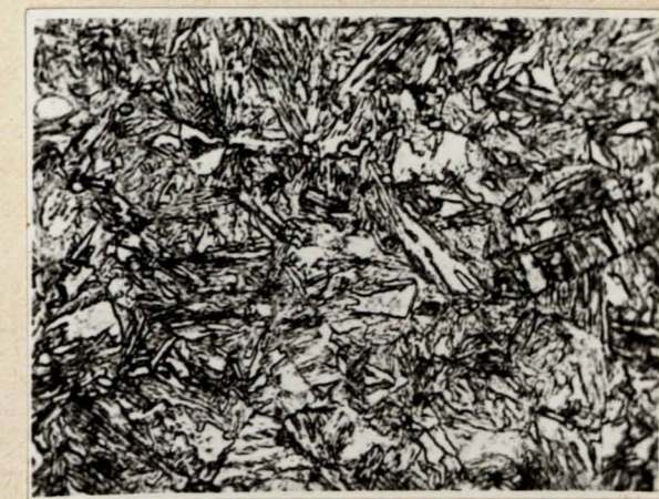
Rys. 13f Struktura stali chłodzonej wg krzywej I
