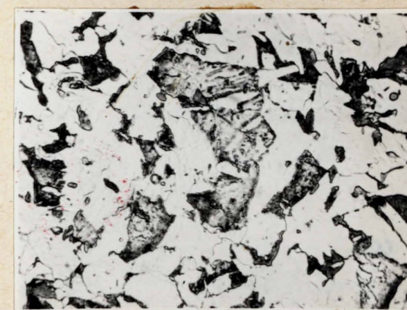
Rys. 9d Struktura stali chłodzonej wg krzywej III
