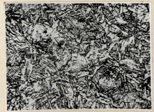
Rys. 12f Struktura stali chłodzonej wg krzywej I
