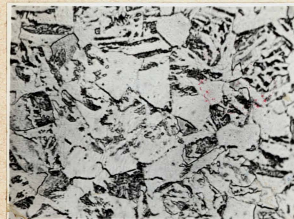
Rys. 11c Struktura stali chłodzonej wg krzywej IV
