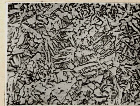
Rys. 14f Struktura stali chłodzonej wg krzywej I
