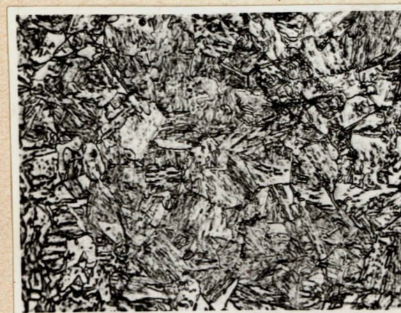
Rys. 13e Struktura stali chłodzonej wg krzywej II
