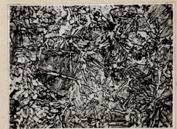
Rys. 8f Struktura stali chłodzonej wg krzywej I
