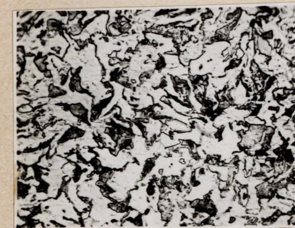
Rys. 8e Struktura stali chłodzonej wg krzywej II
