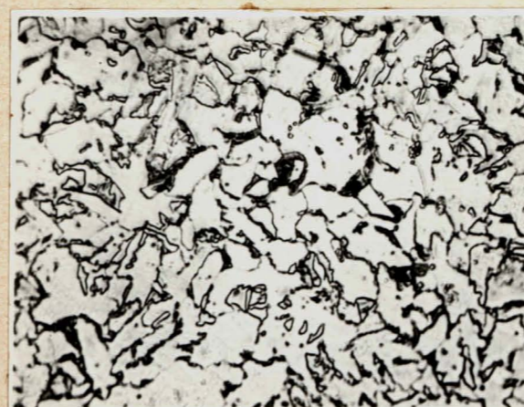
Rys. 14e Struktura stali chłodzonej wg krzywej II
