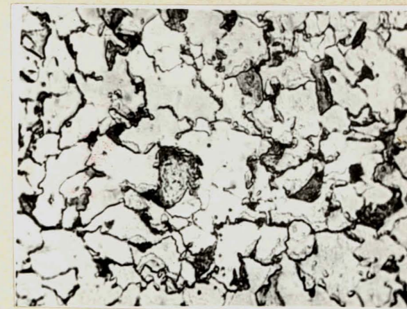
Rys. 14d Struktura stali chłodzonej wg krzywej III
