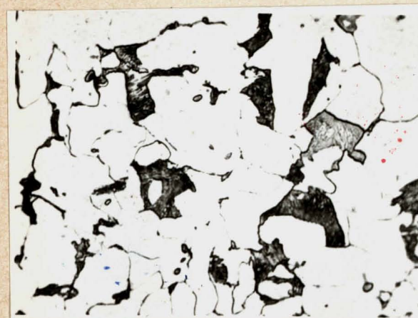
Rys. 10c Struktura stali chłodzonej wg krzywej IV
