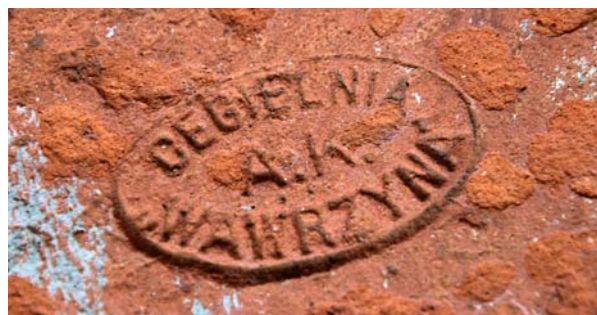
Ryc. 5. Znak jednej z cegielni, z której pochodził materiał użyty do budowy i przebudów budynku biurowego (fot. J. Dąbrowski)
