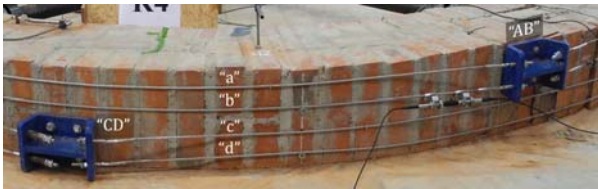
Ryc. 8. Pierścień ceglany wzmocniony obwodowo przy użyciu lin stalowych o średnicy 5 mm
