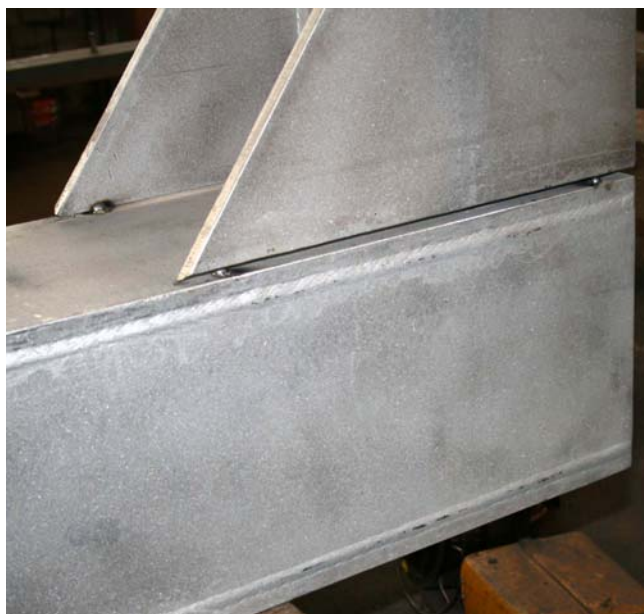
Ryc. 25. Ramię jarzma przed połączeniem z rygłem Fig. 25. Yoke arm before connecting to beam
