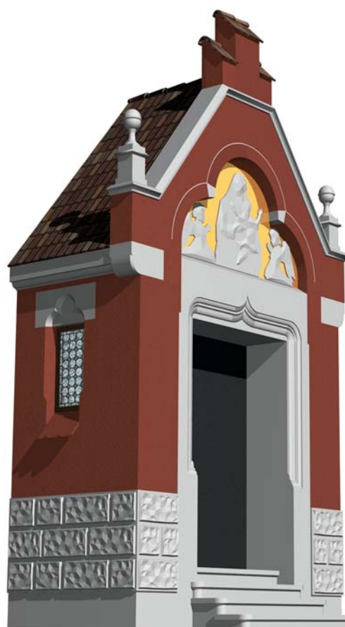
Ryc. 6. Kościół pw. Najświętszego Serca Pana Jezusa, ss. Sercanek, rekonstrukcja podbudowy kruchty wejściowej dowiązanej do pierwotnego poziomu ulicy Fig. 6. The Church of Sister Servants of the Most Sacred Heart of Jesus, reconstruction of the entrance porch substructure tied in with the original street level
