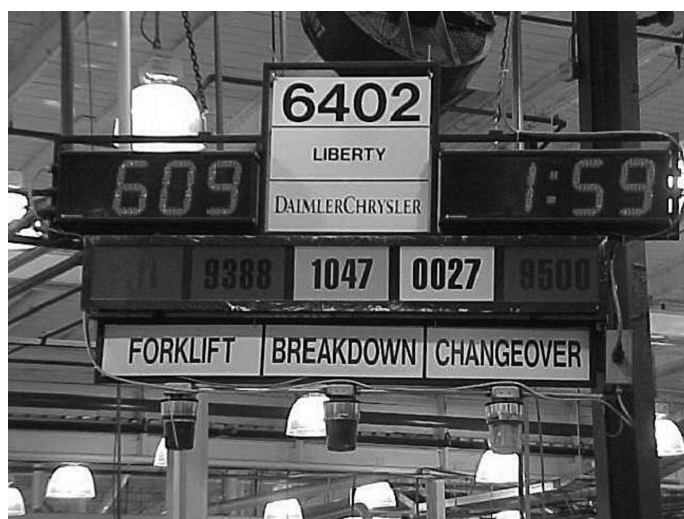
Rys. 1. Przykład systemu andon [7]
