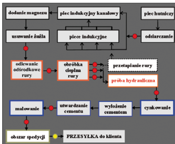
Rys. 4. Schemat systemu kontroli jakości zatwierdzonego przez ISO 9001 Fig. 4. System diagram of the quality control approved by ISO 9001
