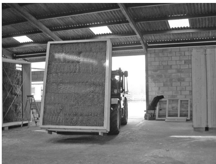
II. 1. Panele ModCell® prefabrykowane w lokalnej „Flying Factory®” (źródło: www.modcell.com )
