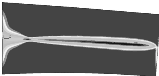
Rys. 5. Rozkład naprężenia zredukowanego wg hipotezy HMH
