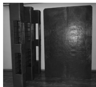
Rys. 4. Europalety z recyklatów polietylenu z 15% dodatkiem tufu [18]
