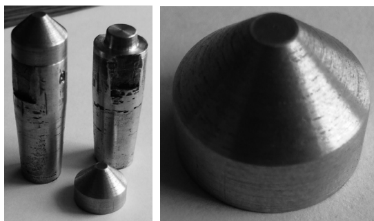
Rys. 6. Nasadkowe końcówki elektrod wykonane z kompozytu z tufem (badania własne)
