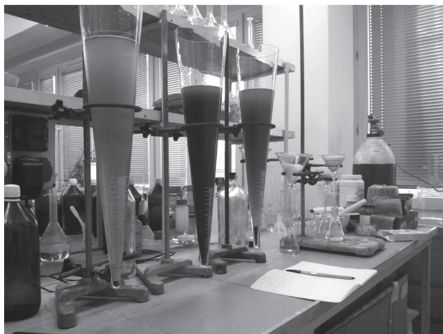
Rys. 6. Oznaczanie zawiesin łatwo opadających w lejach Imhoffa
