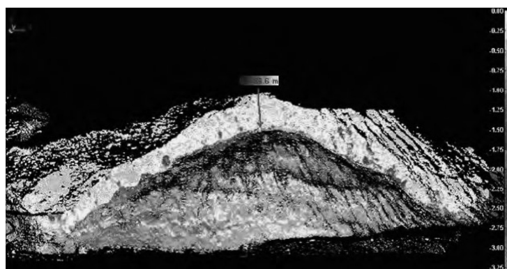
Rys. 9. Pomiar całkowitego przemieszczenie osuwiska utworzonego z moreny czołowej lodowca Belvedere [3]
