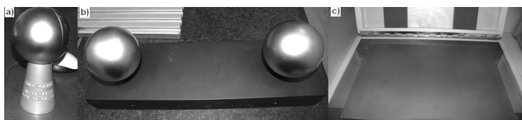
Rys. 2. Wzorce do testów akceptacji dla: a) błędu układu głowicy optycznej, b) błędu wskazania na długości, c) błędu płaskości
