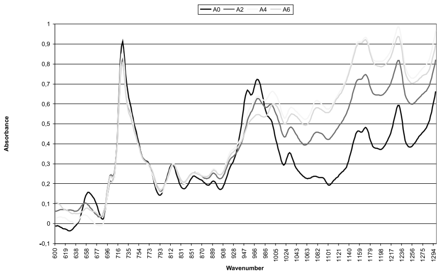
Rys. 3. Widmo IR OSM „Shell Rimula Ultra R4L 15W-40” po przebiegu pojazdu: A0 – 0 km, A2 – 20 000 km, A4 – 40 000 km, A6 – 60 000 km [4]
