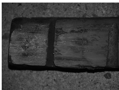
Rys. 4. Pęknięcie promieniowe żeliwnej wstawki hamulcowej po teście św. Gotarda
