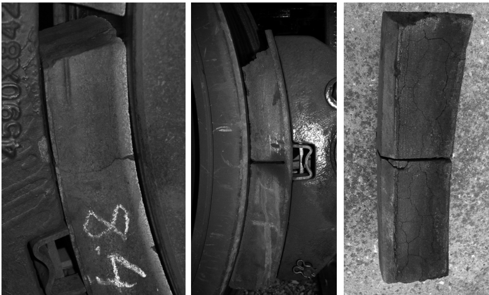
Rys. 2. Kompozytowe wstawki hamulcowe po teście św. Gotarda
