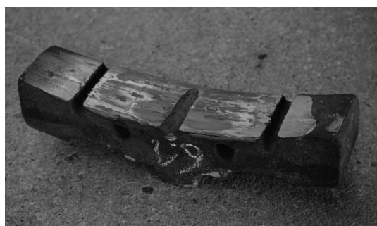
Rys. 5. Żeliwna wstawka hamulcowa po teście św. Gotarda
