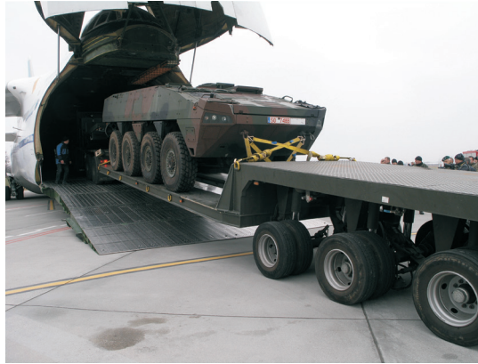
Rys. 3. Widok uniesionej platformy w momencie pokonywania rampy załadunkowej samolotu
