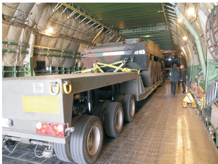
Rys. 9. Widok gotowej platformy wprowadzonej do ładowni samolotu AN-124 Fig. 9. View of ready platform introduced into the freight hold of the plane AN-124
