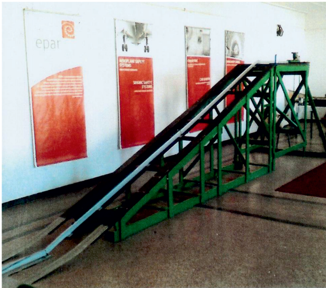
Fot. 2. Użyty do badań obiekt (wózek) i pochylnia do nadawania obiektowi prędkości (energii kinetycznej)
