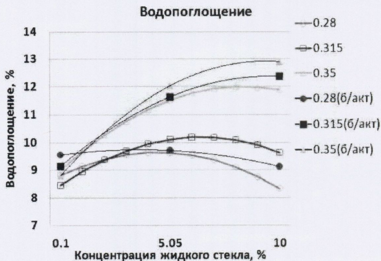
Рис.2. Зависимость водопоглощения цементного камня от концентрации жидкого стекла при водоцементных отношениях: 0,28, 0,315 и 0,35 для образцов на механоактивированных растворах; 0,28(б/акт), 0,315(б/акт) и 0,35(б/акт) для образцов на неактивированных растворах жидкого стекла
