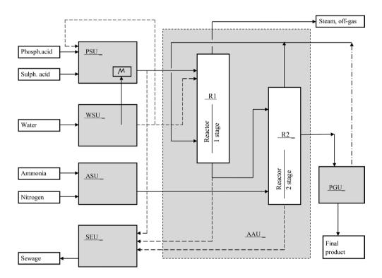
Fig. 2. Schematic block representation of the pilot plant Rys. 2. Schemat blokowy instalacji pilotażowej
