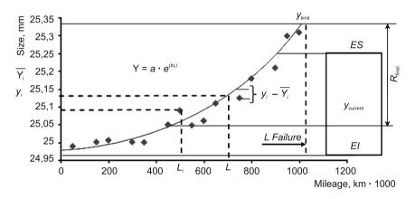
Fig. 2. Approximating function of the parts surfaces wear out Rys. 2. Aproksymatywne funkcje zużycia powierzchni części
