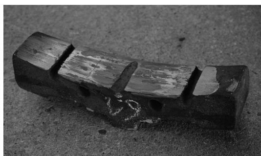
Rys. 5. Żeliwna wstawka hamulcowa po teście św. Gotarda
