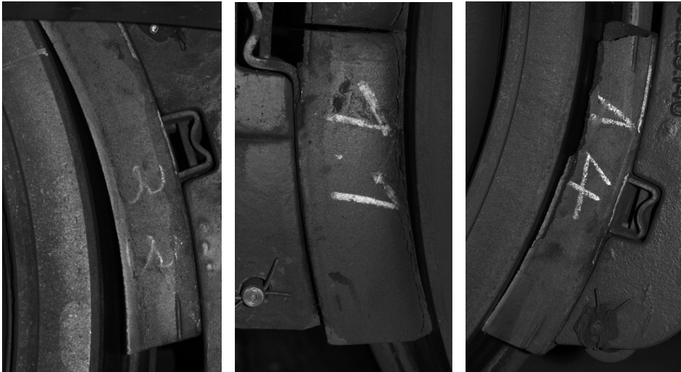
Rys. 1. Kompozytowe wstawki hamulcowe po teście św. Gotarda
