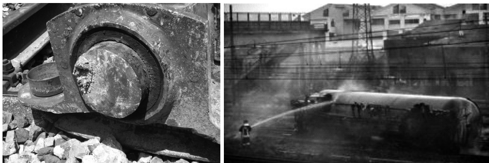
Rys. 4. Widok na pękniętą oś w miejscu korozji powierzchniowej osi, która spowodowała wykolejenie wagonu cysterny we włoskim Viareggio
