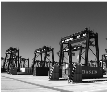
Rys. 4. Szynowe suwnice bramowe Fig. 4. Rail-mounted gantry (RMG)
