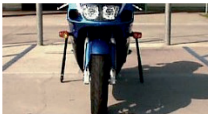
Rys. 1. Motocykl z podporowymi kółkami pomocniczymi dla osób z dysfunkcją nóg [4]
