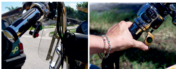
Rys. 4. Przyciski sekwencyjnej zmiany biegów obsługiwane ręcznie [4]
