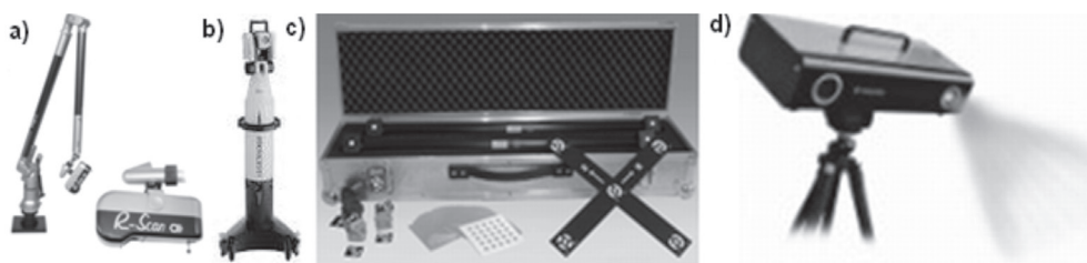
Rys. 1. a) Ramie pomiarowe Omega 2025 firmy Romer wyposażone w głowicę skanującą R-SCAN, b) Laser Tracer, c) system fotogrametrii, d) system działający na zasadzie światła strukturalnego
