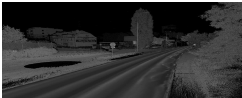
Rys. 12. Laserowy obraz odcinka ul. Słowackiego w Gdańsku [10]
