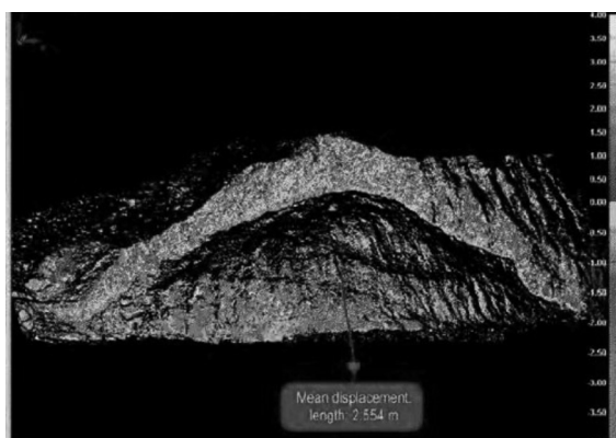
Rys. 8. Wyniki przemieszczenia osuwiska utworzonego z moreny czołowej lodowca Belvedere otrzymane z dwóch pomiarów skanerem laserowym [3]
