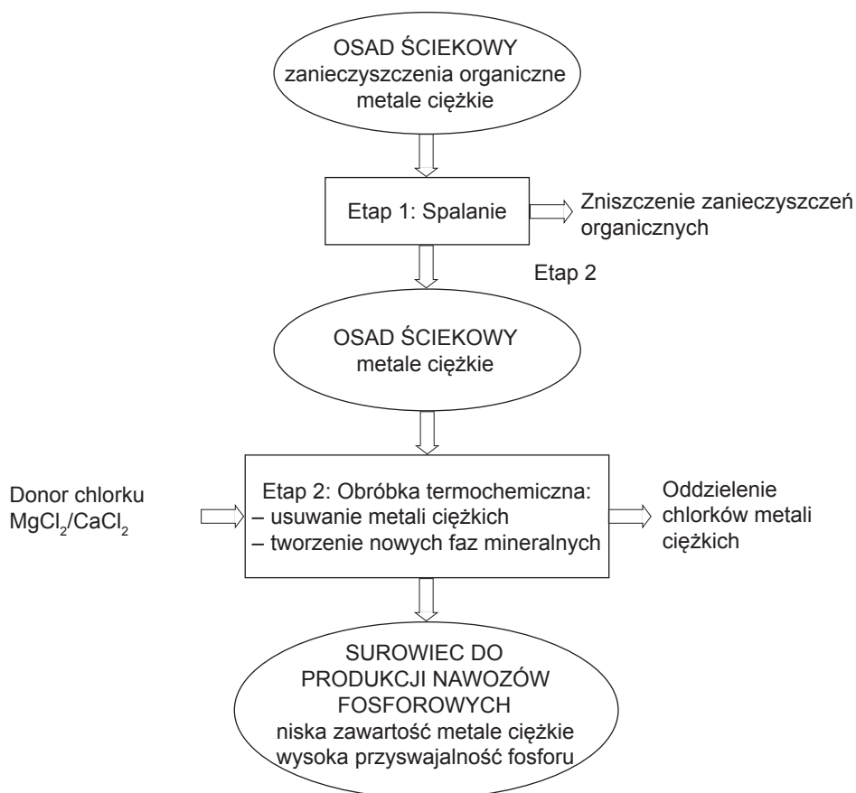
Rys. 2. Schemat termochemicznej obróbki osadu ściekowego [2]
