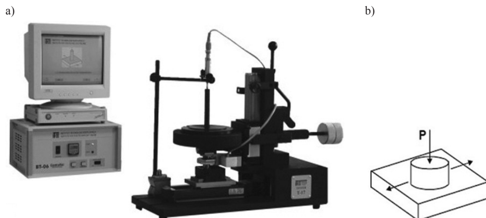
Rys. 3. Tester T-17 typu trzpień-tarcza do badania tarcia i zużycia materiałów konstrukcyjnych w ruchu posuwisto-zwrotnym (a), schemat próby (b) [30]
