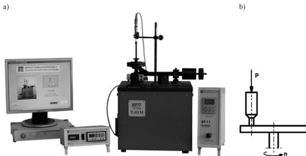
Rys. 2. Urządzenie T-01M typu trzpień-tarcza do badania tarcia i zużycia materiałów konstrukcyjnych w ruchu obrotowym (a), schemat próby (b) [30]
