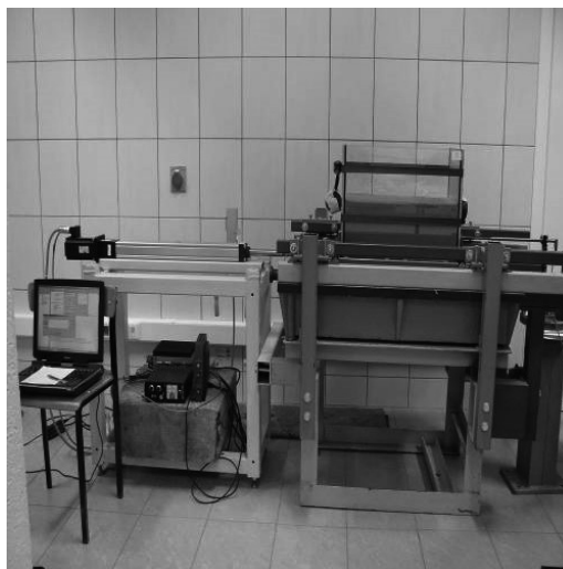
Rys. 3. Stół sejsmiczny z akwarium wypełnionym gruntem (fot. M. Kulczykowski)
