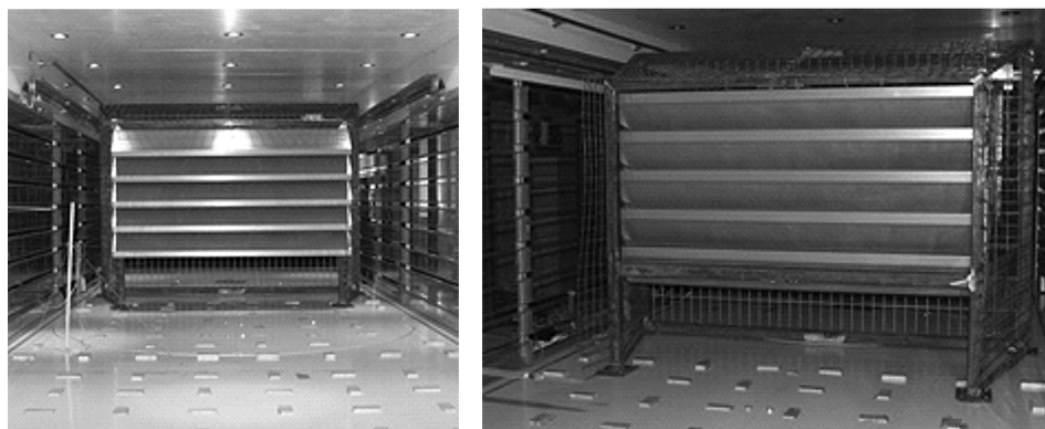
Rys. 1. Widok zestawu pięciu paneli w przestrzeni pomiarowej tunelu aerodynamicznego w dwóch konfiguracjach kierunku wiatru: a) z przodu paneli; b) z tyłu paneli
