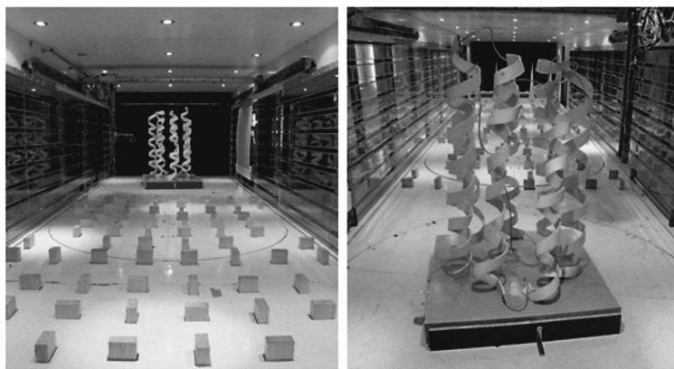
Rys. 2. Widok modelu w przestrzeni pomiarowej tunelu aerodynamicznego
