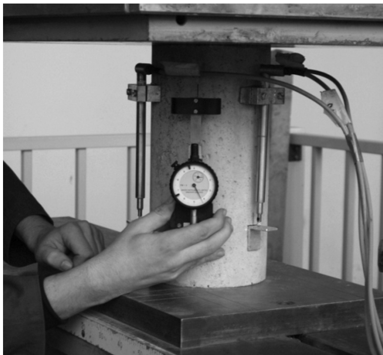
Rys. 4. Pomiar odkształceń betonu na stanowisku badawczym
