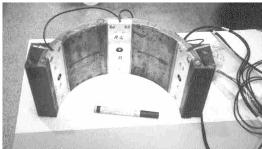
Rys. 3. Potrójny pomiar sił (odkształceń) na zewnętrznym pierścieniu łożyska
