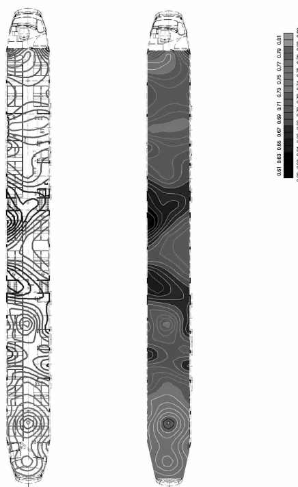
Rys. 15. Rozkład parametru RASTI w tramwaju NGT6 Fig. 15. Distribution on the parameter RASTI in the NGT6 tram
