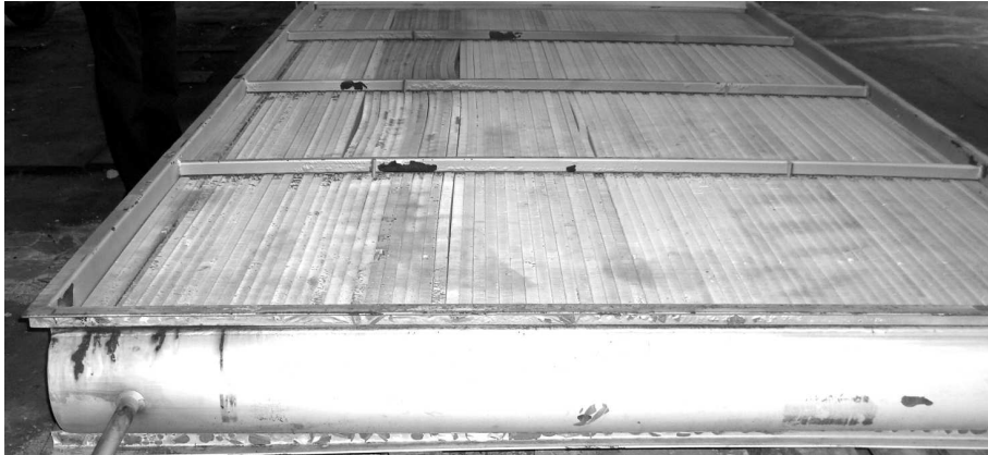
Fig. 2. The tube bundle in the high performance heat exchanger Rys. 2. Widok wyboconych rurek wysokosprawnego wymiennika ciepła
