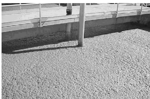
Rys. 13. Piana spowodowana nadmiernym rozwojem bakterii M. parvicella [61] Fig. 13. Foam caused by excessive growth of Microthrix parvicella
