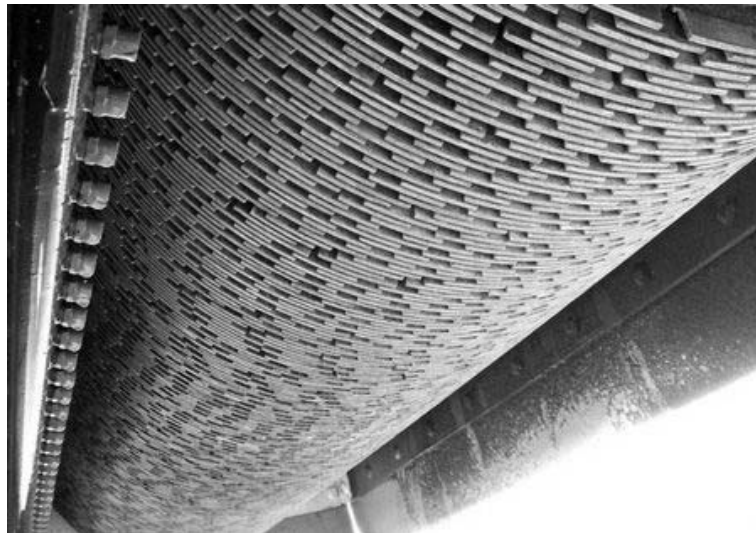
Rys. 2. Bęben szlifujący składający się z szeregu tarcz diamentowych [7]
