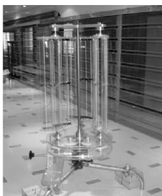
Rys. 1. Model turbiny karuzelowej z planetarnym ruchem łopatek w tunelu aerodynamicznym Laboratorium Inżynierii Wiatrowej Politechniki Krakowskiej
