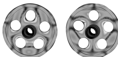
Rys. 14. Postacie drgań odpowiadające częstotliwości \omega_{31} przy prędkości kątowej koła \theta = 80 rad/s Fig. 14. The mode shapes corresponding to frequency \omega_{31} at the gear angular velocity \theta = 80 rad/s
