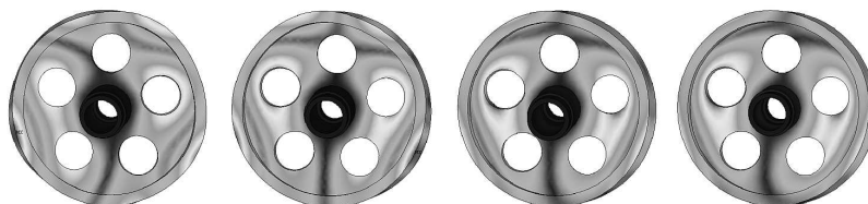
Rys. 4. Postacie drgań odpowiadające częstości \omega_{21} (pierwsza forma)
