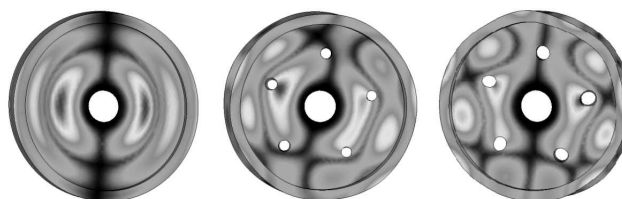
Rys. 15. Postacie drgań odpowiadające częstotliwości \omega_{31} (model pomocniczy) Fig. 15. The mode shapes corresponding to frequency \omega_{31} (auxiliary model)
