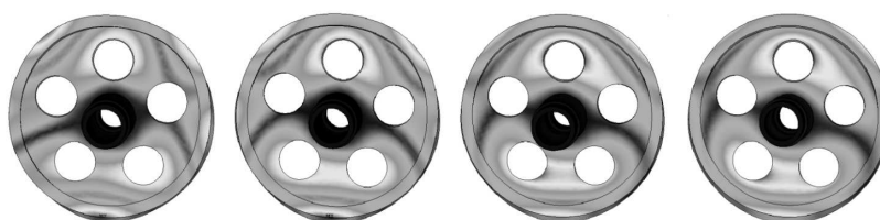
Rys. 5. Postacie drgań odpowiadające częstości \omega_{21} (druga forma)
