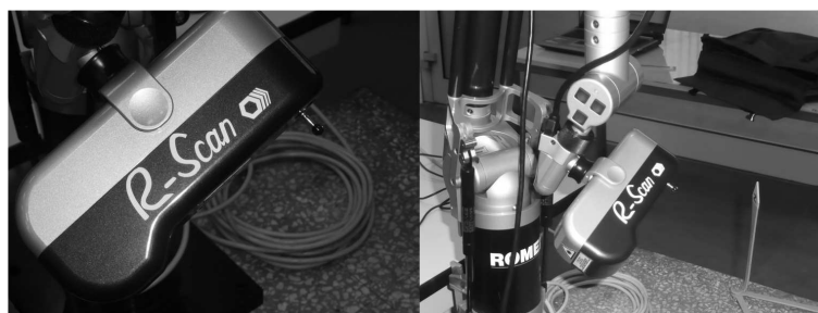
Rys. 1. Współrzędnościowe ramię pomiarowe wraz z głowicą pomiarową Fig. 1. Coordinate measurement arm with measuring head
