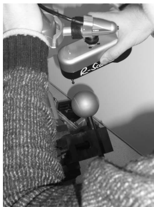
Rys. 2. Proces skanowania obiektu 3D za pomocą współrzędnościowego ramienia pomiarowego
