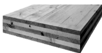
CLT ( Cross Laminated Timber ) - drewno laminowane krzyżowo;
