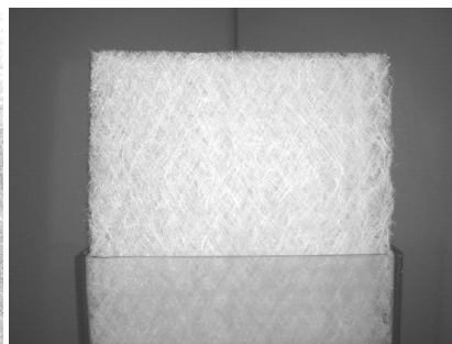
Il. 3. Włókno szklane w zestawie TIMax GL (źródło: www.wacotech.de)
