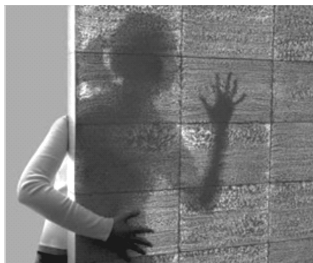
II. 5. Litracon – przezroczysty beton (źródło: http://www.litracon.hu )
