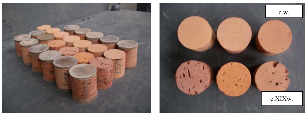
Rys. 1. Wycięte z cegieł próbki walcowe o średnicy 50 mm przygotowane do badań wytrzymałościowych (c.w. – cegły współczesne, c. XIX w. – cegły rozbiórkowe z końca XIX w.
